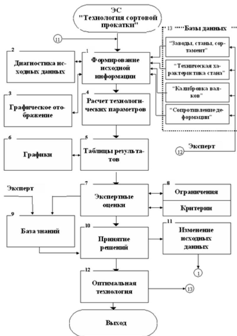
Рисунок 1 – Структурная схема экспертной системы технологии сортовой прокатки
