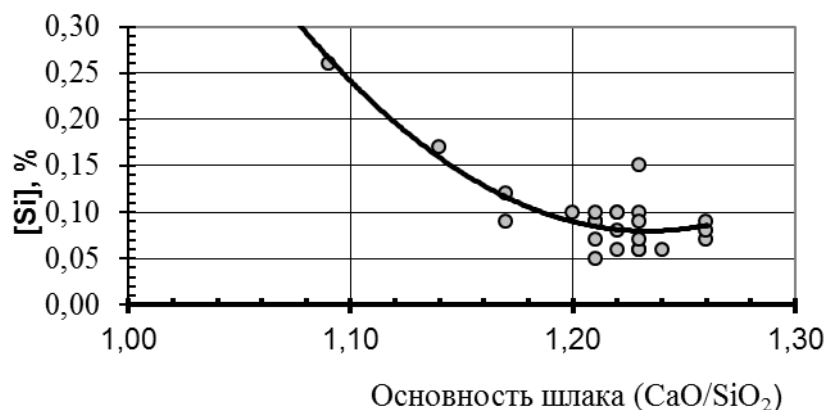
Рисунок 7 – Взаимосвязь содержания кремния в чугуне и основности шлака
