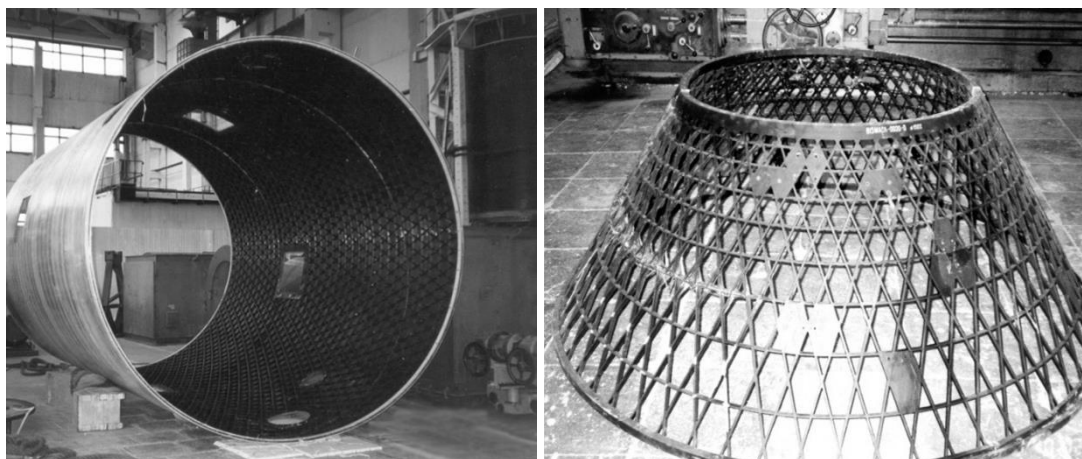
Рисунок 1 – Сетчатые конструкции из композиционных материалов
