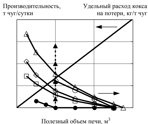
Рисунок 2 – Влияние объема ДП на производительность (—) и расхода кокса (Δ) – по И. Ф. Курунову. Изменение расхода кокса на внешние потери теплоты доменных печей по В. Г. Воскобойникову и Ю. И. Гофману – (O), А. В. Бородулину в 1986 г. (◇) и в 1974 г. (□), И. Г. Товаровскому, З. И. Некрасову и Я. М. Ободану в 1977 г. (●), инструментальные замеры теплотехников ИЧМ НАНУ (▲)
