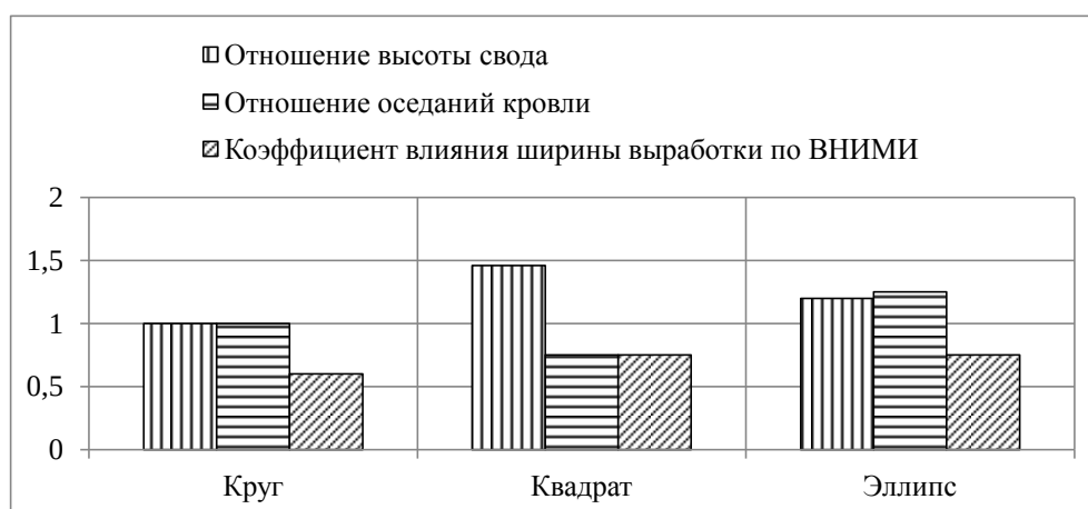
Рисунок 5 – Гистограмма распределения отношений геомеханических параметров при различных формах поперечного сечения выработок
