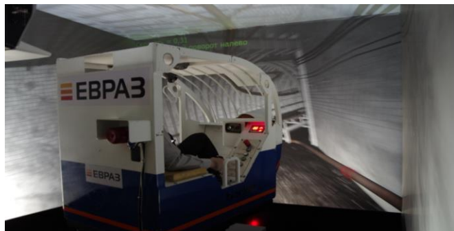
3D тренажер дизель-гидравлических локомотивов Bevox, Becker
