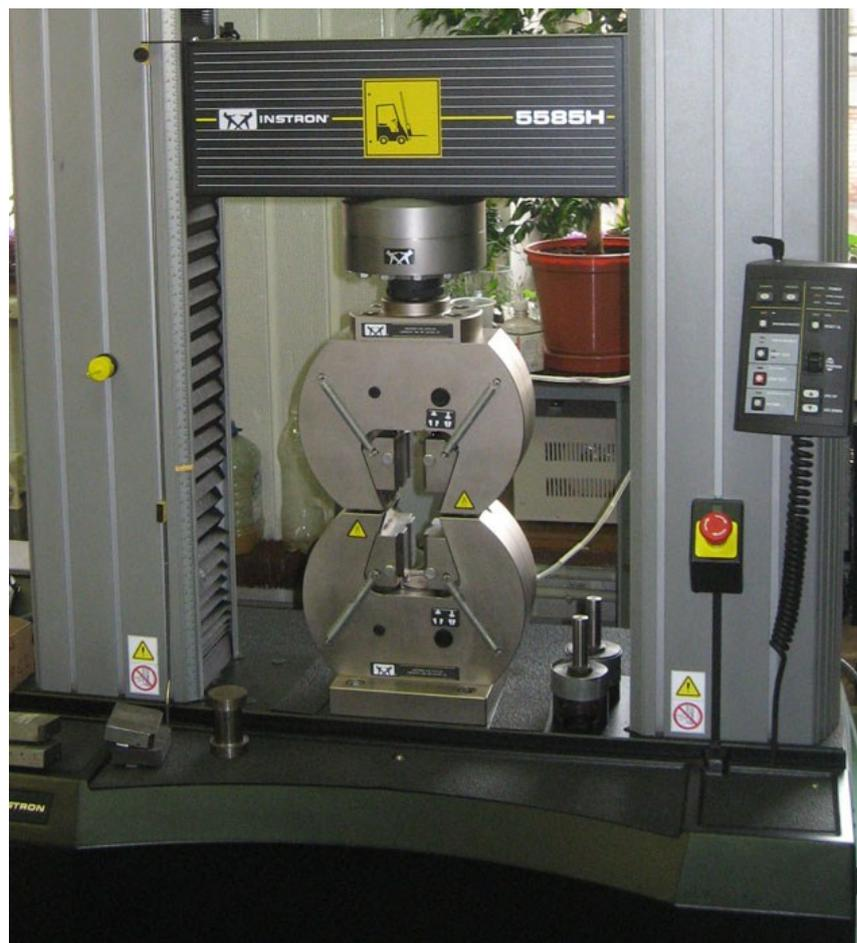
Универсальная испытательная машина растяжение, сжатие, изгиб, сдвиг
