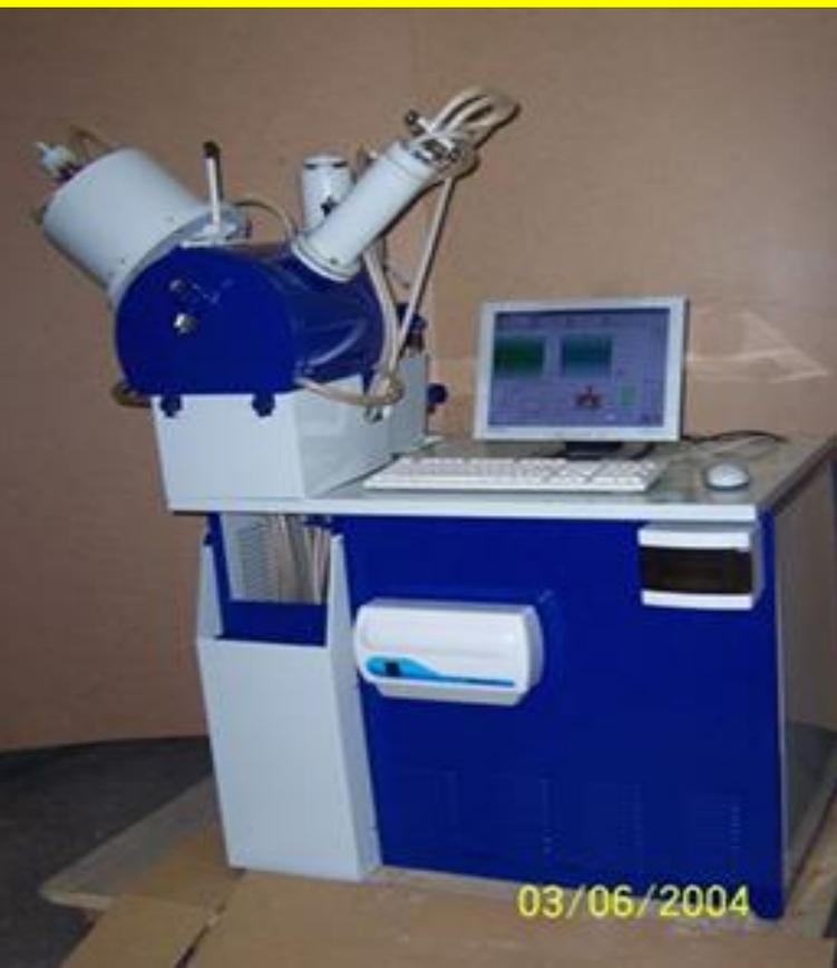
**Установка применяется для научных и технологических исследований в области физики плазмы и физики упрочнения и модификации поверхности, а также промышленной обработки партий мелкогабаритных изделий и инструментов.**
