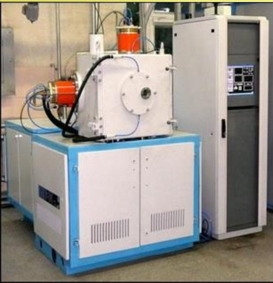
В вакуумном объеме создается азотная плазма с концентрацией ( $10^9 - 10^{11}$ )  $\text{см}^{-3}$ , при помещении в которую обрабатываемой детали и подаче на нее отрицательного потенциала ионы азота из плазмы ускоряются в направлении обрабатываемой поверхности и попадают на нее, разогревая обрабатываемую деталь.
