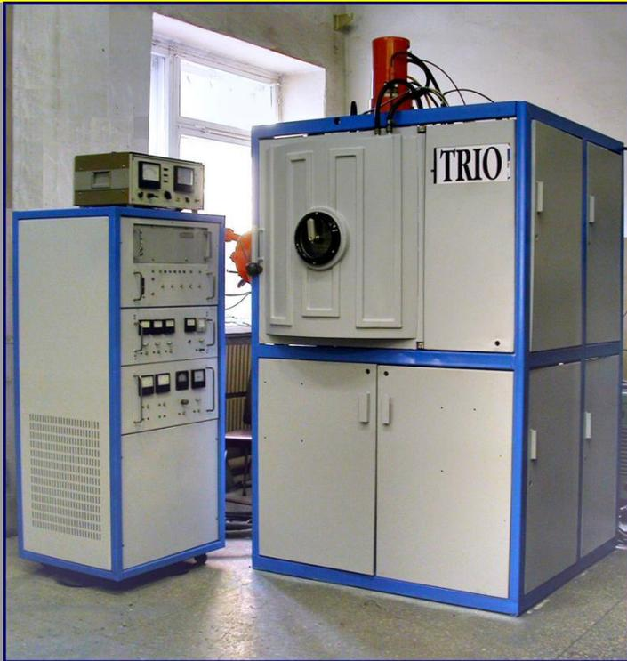
**Покрытия формируются в результате конденсации потока плазмы материала эродирующего катода на поверхности образцов (любой металл, сплав или композит на основе металла).**
