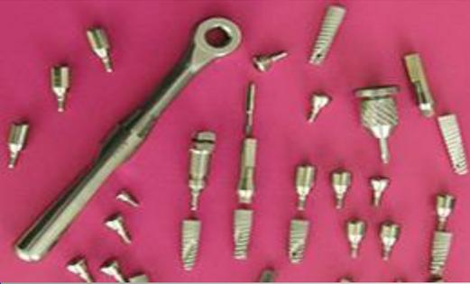
Наноструктура получена методом интенсивной пластической деформации предназначены для внутрикостной имплантации.
