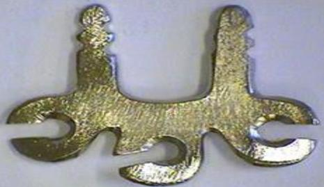
Предназначен для медицины, изготовлен из никелида титана (NiTi) с модифицированным поверхностным слоем, не содержащим никеля. Предназначен для обеспечения высокой коррозионной стойкости и биосовместимости с костными тканями стоматологических имплантатов, устанавливаемых через лунку свежееудаленного зуба.
