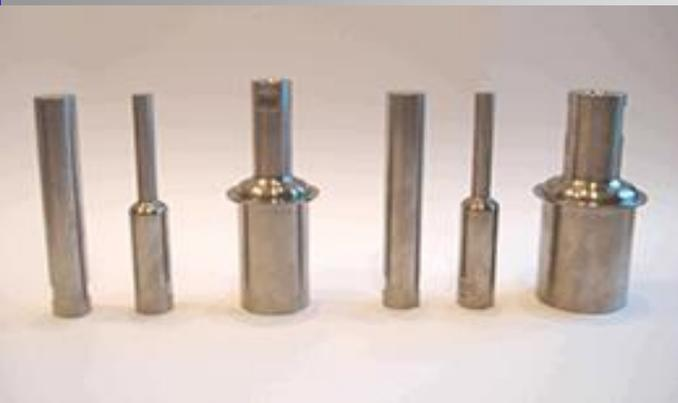
*Наноструктура* в крупногабаритных заготовках титановых сплавов получена путем механотермической обработки с использованием методов интенсивной пластической деформации.
