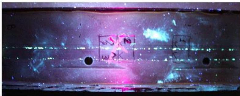
Рис. 2. Свечения в зоне сварного соединения
