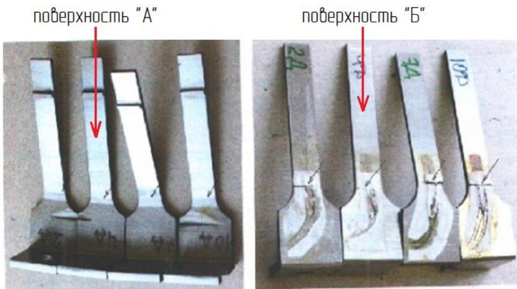
Рис. 12. Внешний вид и место разрушения образцов (указано стрелкой) с утолщенными границами зерен
