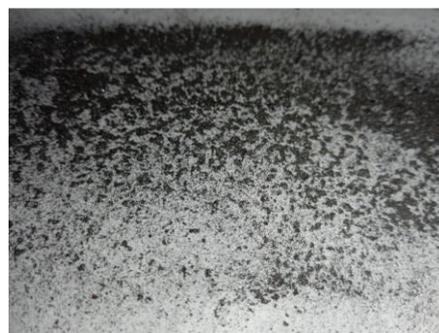
Рис. 4. Микрочастицы металла, образованные в результате износа контртела и образца из стали марки 5XNM после ХТО
