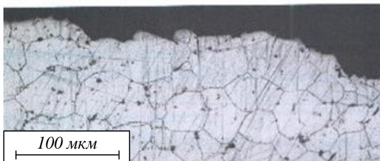
Рис. 13. Микроструктура основного материала около зоны излома образца по основному материалу
