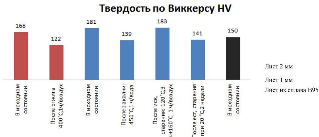
Рисунок 4 – Результаты измерения твердости полученных листов из модельного сплава АЦ6Н0,5Ж
