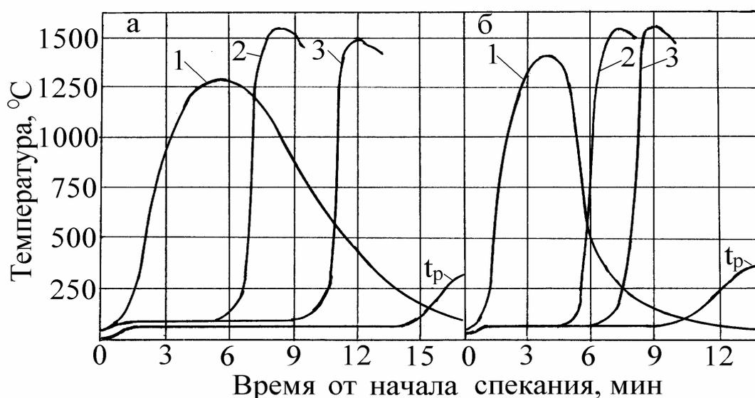
а – базовые спекания при 5 % С в шихте и 30 % возврата; б – опыты с перераспределением топлива ( $C_{\text{общ.}} = 6,96 \%$ ) в верхнем слое (в) / в нижнем слое (н) = 19,0 / 2,0 и возврата ( $V_{\text{общ.}} = 58,4 \%$ ) в / н = 12,3/81,2; 1, 2, 3 (цифры у кривых) – номер термопары (сверху вниз),  $t_p$  – температура отходящих газов под решеткой.
