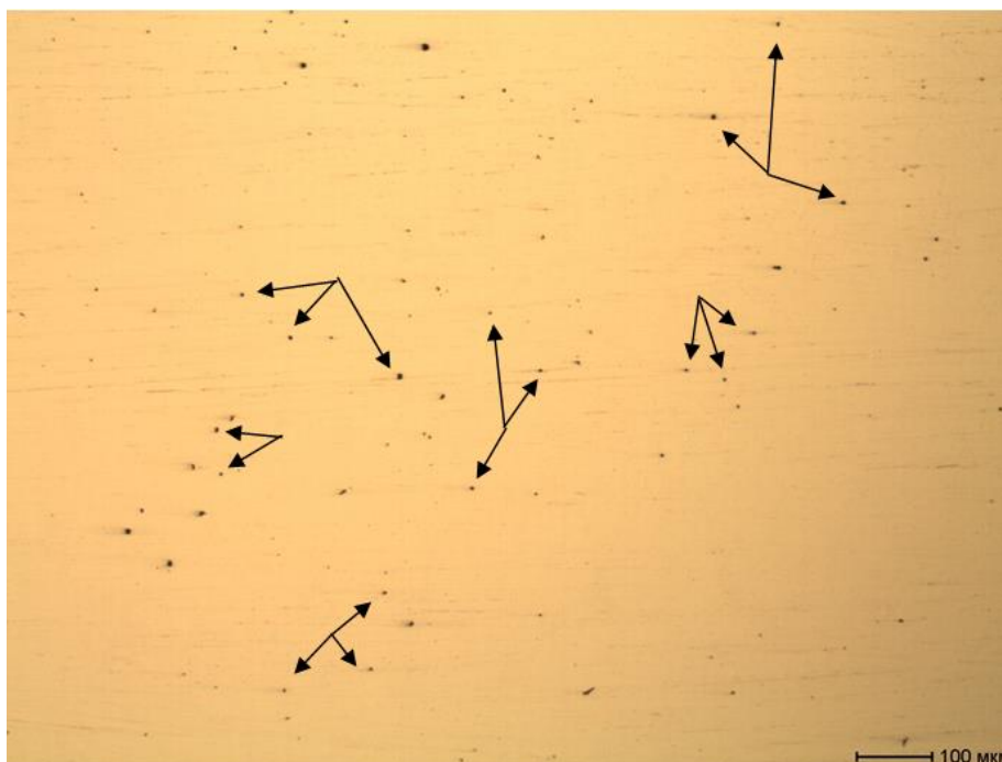
Рисунок 5. Оксиды точечные на заготовках от плавов стали 09Г2С, произведенных по стандартной технологии
