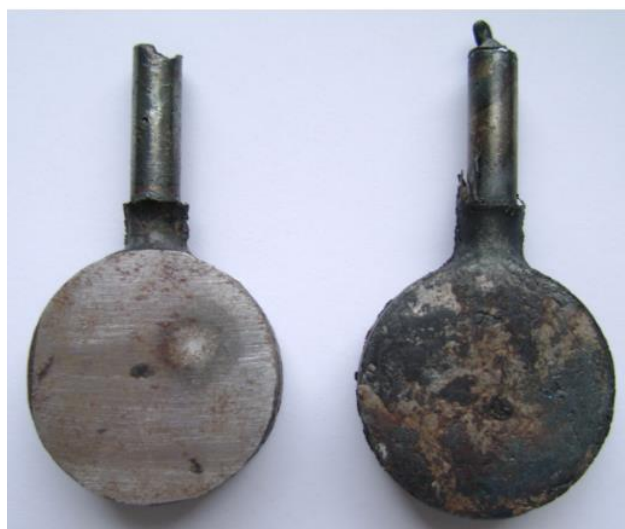
Рисунок 3. Общий вид пробы, полученной пробоотборником «ЕВРАЗСАМП ES»
