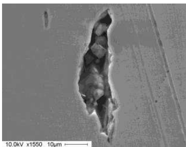
Рисунок 8. Неметаллические включения на заготовках от плавов стали 09Г2С, произведенных с использованием новой технологии продувки
