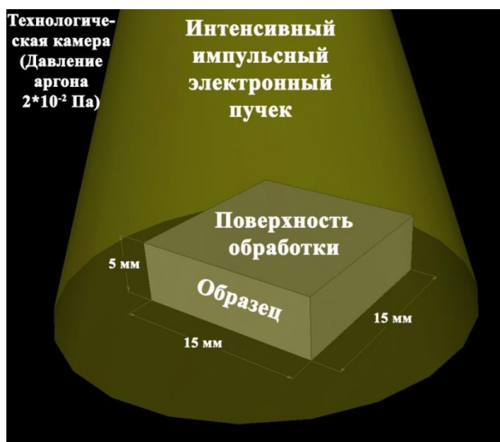
Рисунок 2.4 – Размеры и ориентация образца относительно ИИЭП
