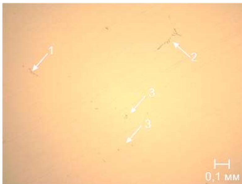
Рисунок 3.14 – Сульфидные включения (1), нитриды строчечные (2) и оксиды точечные (3) в центральной зоне НЛЗ стали марки Э76ХФ
