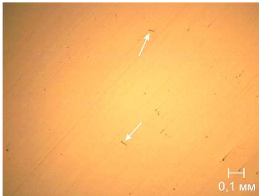
Рисунок 3.10 – Сульфидные включения в зоне столбчатых кристаллов НЛЗ стали марки Э76ХФ
