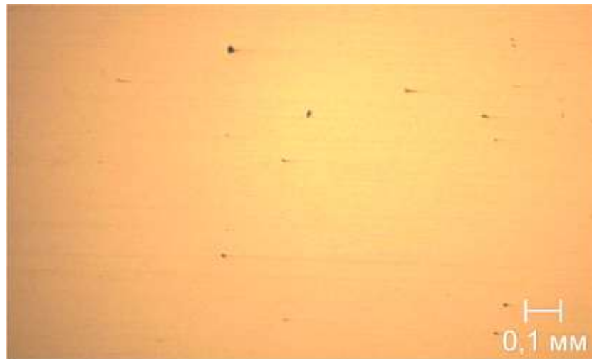
Рисунок 3.18 – Оксиды точечные в зоне столбчатых кристаллов НЛЗ стали марки Э90ХАФ
