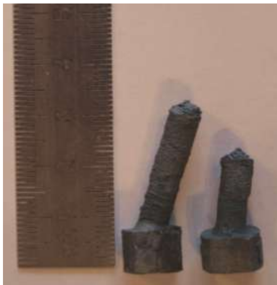
Рисунок 2.5 – Внешний вид образца после излома и охлаждения на воздухе
