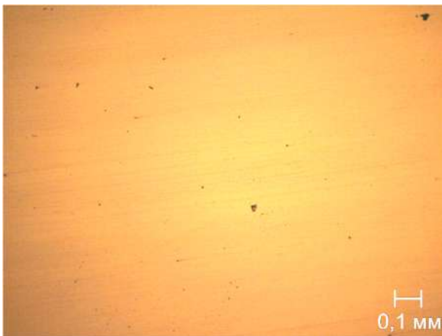
Рисунок 3.9 – Силикаты недеформирующиеся в зоне столбчатых кристаллов НЛЗ стали марки Э76ХФ
