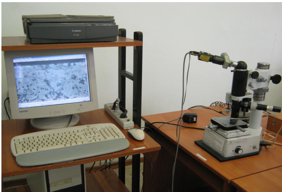
Рисунок 3.21 – Микротвердомер ПМТ-3 и компьютерное изображение отпечатка для расчета микротвердости с помощью системы анализа изображения SIAMS-700
