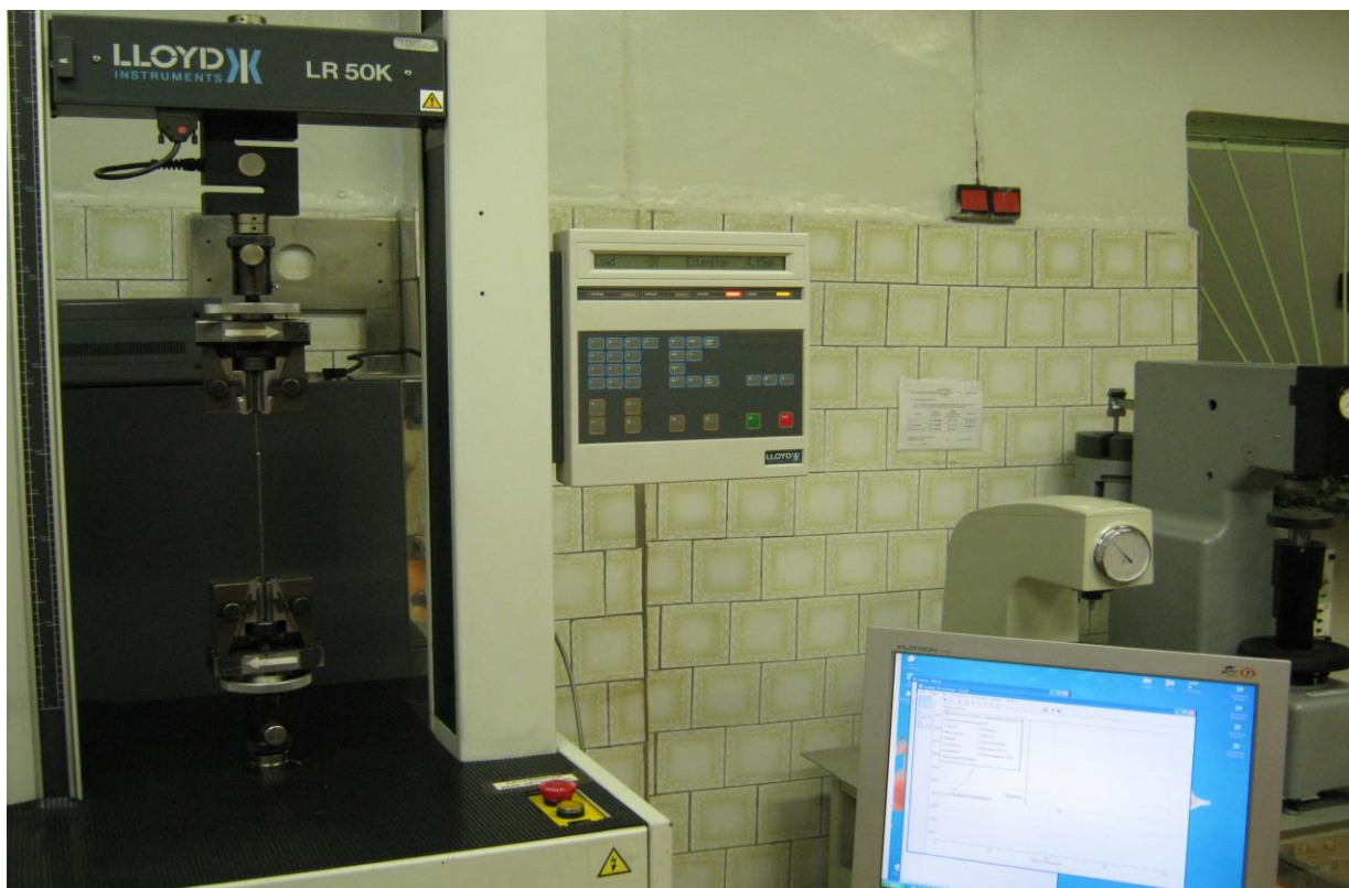
Рисунок 3.22 – Разрывная машина Lloyd LR 50K для испытания на растяжение
