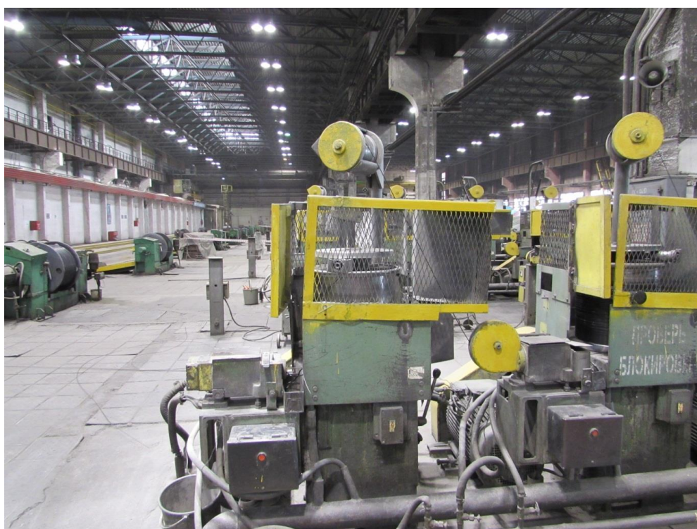
Рисунок 4.8 - Волочильный стан, использованный при опытно-промышленном волочении винтовой арматуры
